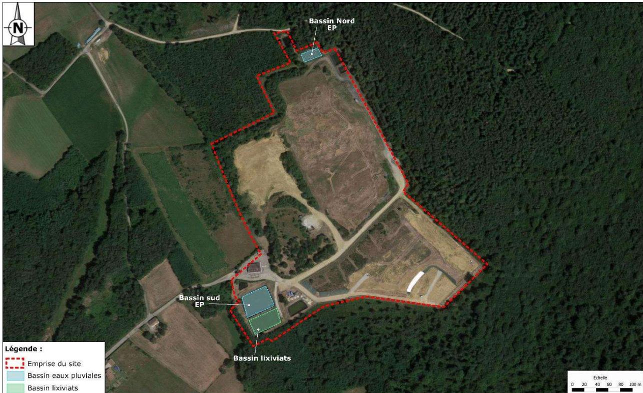
Figure 26 : Localisation des bassins de suivi des eaux superficielles et des lixiviats
